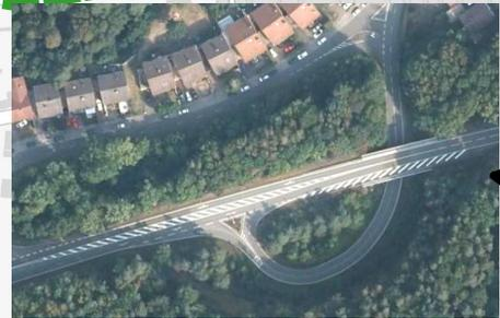
L 363: Prüfung Umbau / Ummarkierung Fahrspuren: westl. Fahrspur würde zum Radweg; Verlegung "bergab"-Spur zur Mitte hin. Radweg bindet an Radweg zur Innenstadt bzw. Mittelbrunner Str.und Klinikum an
