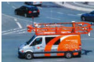
Das orange-silberne Messfahrzeug mit Kameras auf dem Dach, das demnächst durch die Verbandsgemeinde Landstuhl fährt, wird sicherlich vielen Bürgern auffallen. Bei der Befahrung werden die Straßenbestandsdaten und die Details der Bebauung, durch
