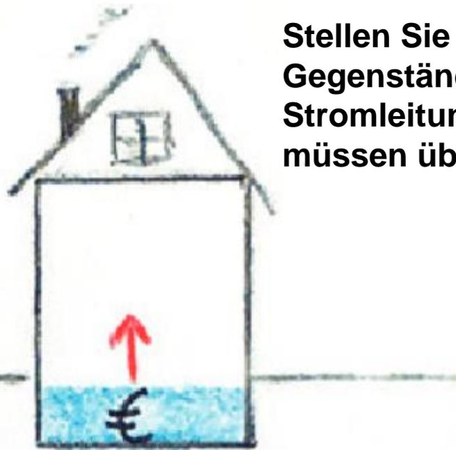
**Stellen Sie keine wertvollen oder sensiblen Gegenstände in gefährdete Bereiche. Stromleitungen und Schaltkästen im Keller müssen überflutungssicher verlegt werden.**
